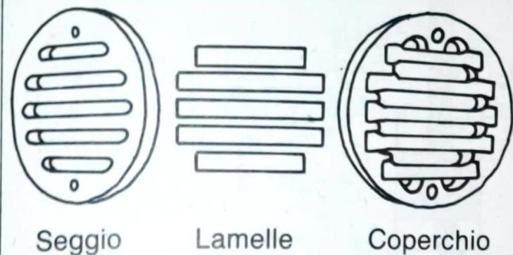
b) valvola a lamelle con sede, elementi flessibili e coperchio della valvola (Worthington) impiegate per aria e basse pressioni;
